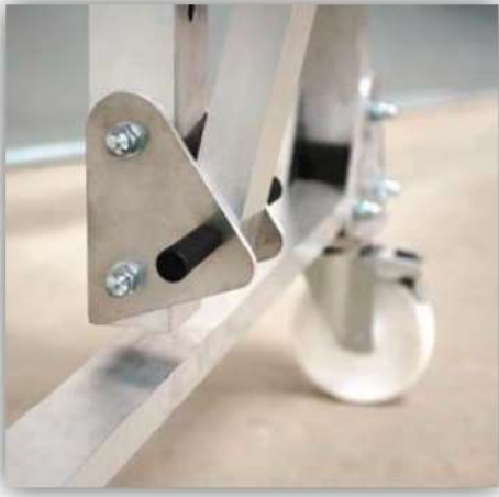
Manivela para ajuste en altura
