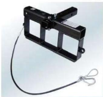
Accesorio de enganche: para llevar las carretillas elevadoras en la parte posterior de los vehículos. (solo para modelos de montacargas)
