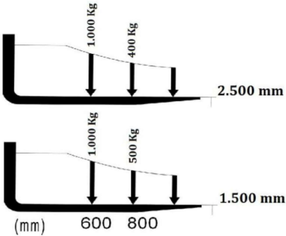
**Apilador carga 1.000 kg. a 2.500 mm**
