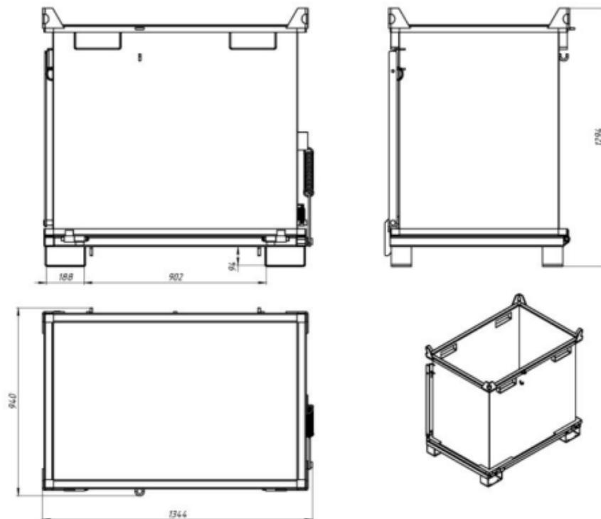
Fig. 1. Contenedor metálico VBB-100
